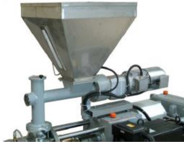
Forzatore per l'alimentazione di un estrusore bivate
