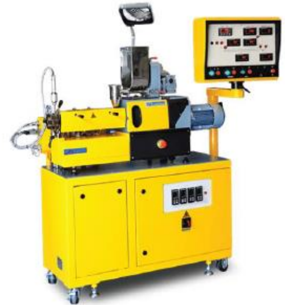
Estrusore bivate da laboratorio (Labtech GmbH)
