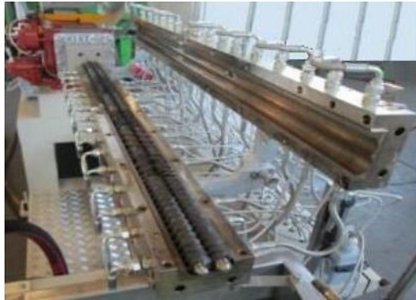
Cilindro per estrusore bivate in due metà aperto. (AMUT S.p.A.)
